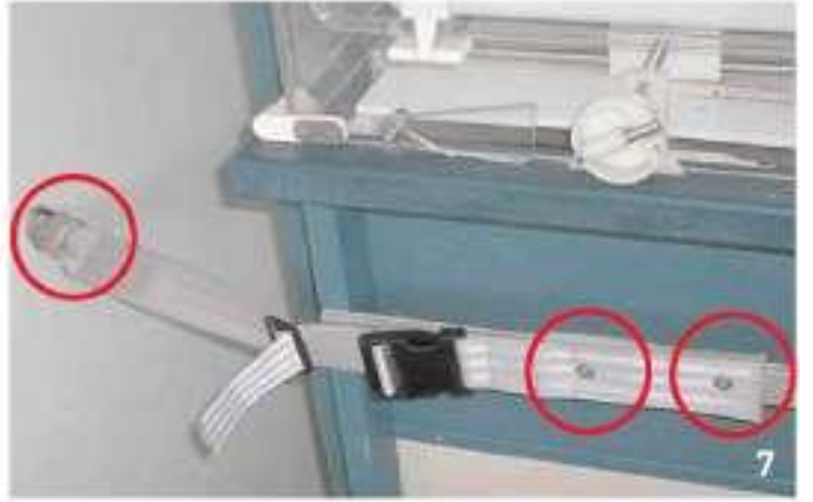
Bağlantı elemanı (dokuma kayış) duvara ve küvöze cıvatalanmıştır. Aynı zamanda küvözün tekerleklerinin kilitli tutulması gerekir.
